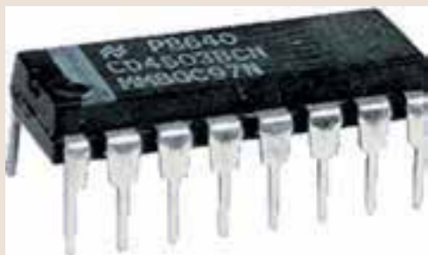
شکل ۴-۷۵ یک نمونه آی سی CMOS
