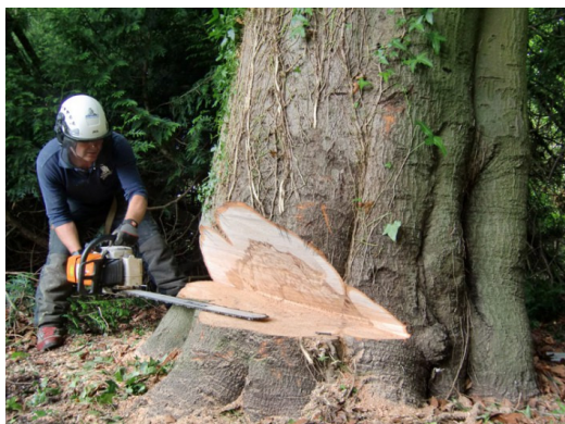
شکل ۵-۵. ایجاد زیر برش به‌وسیله اره موتوری.
