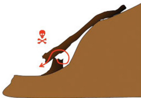
شکل ۵-۲. قطع درخت به طرف بالای دامنه شیب‌دار و سر خوردن آن به سمت پایین شیب.
