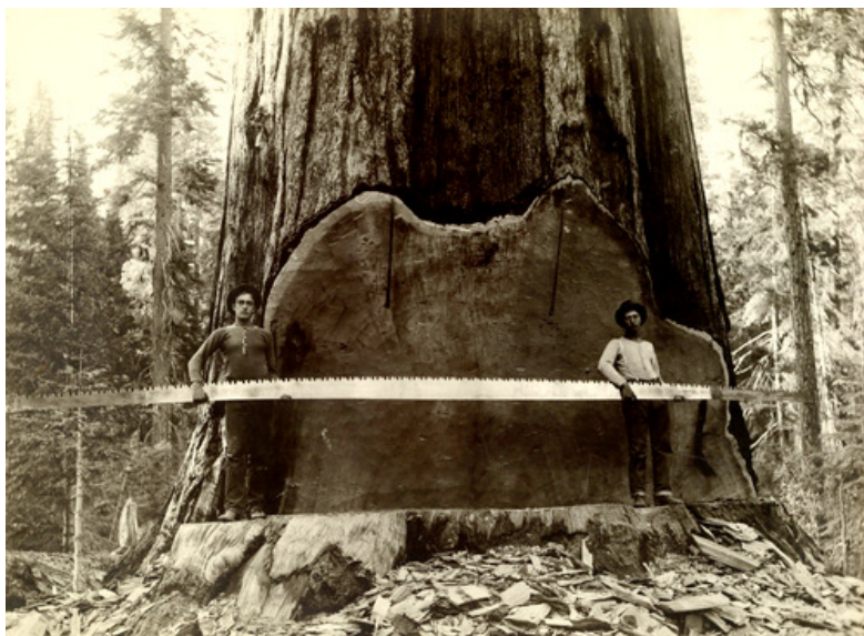
شکل ۴-۴. برش درخت سرخ چوب (سکویا) توسط اره دستی دو نفره از نوع راست پشت.
