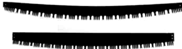
شکل ۴-۳. اره‌های دو سر دستی، شکل بالا اره پشت کمانی و پایین اره راست پشت (پشت صاف).
