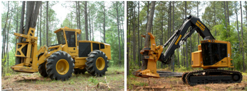
شکل ۴-۱۴. سمت راست فلر بانچر چرخ زنجیری با بازوی بزرگ، سمت چپ فلر بانچر چرخ لاستیکی با بازوی کوتاه (برای درختان قطور).
