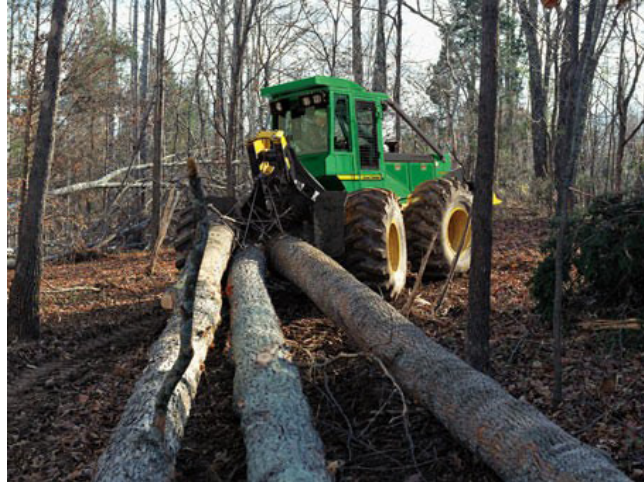
شکل ۴-۱۸. اسکیدر کابل دار در حال انتقال گرده‌بینه‌ها به خارج از منطقه بهره‌برداری می‌باشد.
