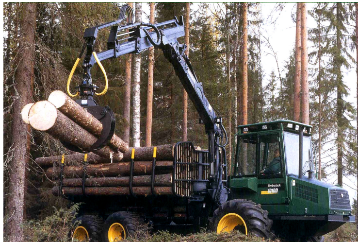
شکل ۴-۱۹. ماشین فورواردر در حال انتقال گرده‌بینه به قسمت بار.
