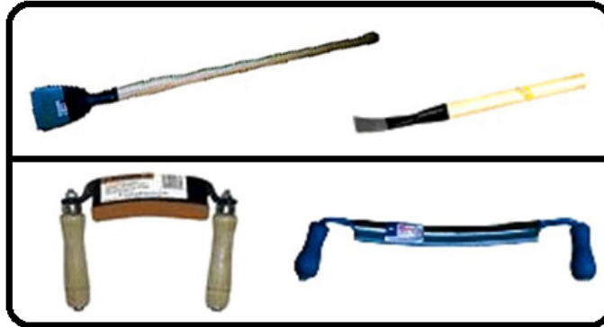
شکل ۴-۸. قسمت بالا بیلچه‌های پوست‌کن، قسمت پایین پوست تراش.
