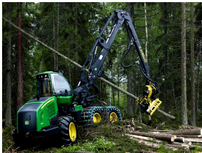
شکل ۴-۱۶. ماشین هاروستر در حال قطع و تبدیل درخت.
