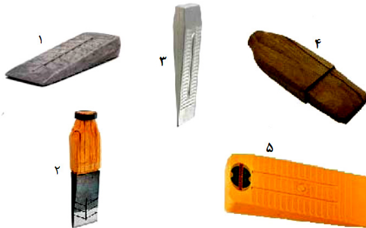
شکل ۴-۲. انواع مختلف گوه: (۱) گوه فولادی (۲) گوه فولادی با دسته چوبی (۳) گوه آلومینیومی (۴) گوه چوبی (۵) گوه پلاستیکی.
