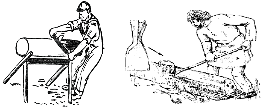
شکل ۴-۹. پوست‌کنی توسط بیلچه در سمت راست و توسط پوست تراش بر روی خردک در سمت چپ.
