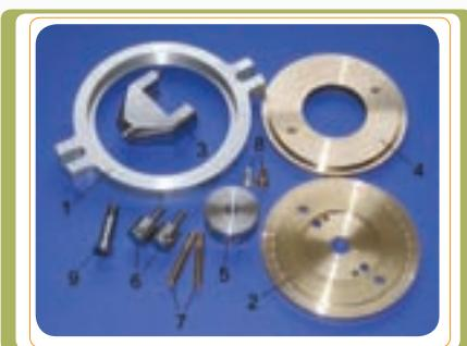
این مجموعه از تعدادی قطعه مجزا تشکیل شده، که برای ساخت هر کدام از آن‌ها لازم است نقشه‌های اجرایی مختلفی تهیه شود. همچنین تهیه یک «نقشه ترکیبی» برای این مجموعه می‌تواند به درک ارتباط قطعات با همدیگر و موقعیت آن‌ها کمک کند و در حین «مونتاژ قطعات<sup>۱</sup>» نیز مفید واقع گردد.
