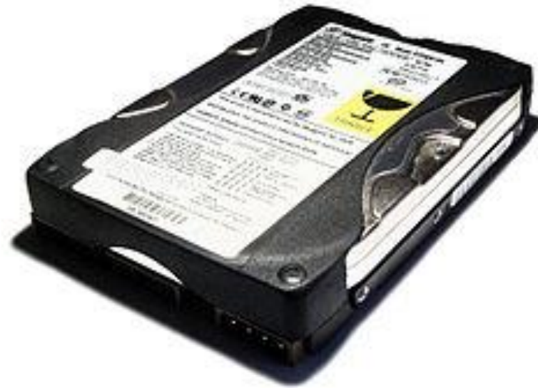
یک دیسک سخت ۴۰ گیگابایتی، نمونه‌ای از یک ذخیره‌ساز داده کامپیوتری
