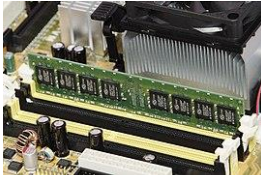
یک SDRAM یک گیگابایتی، نمونه‌ای از یک ذخیره‌ساز داده کامپیوتری
